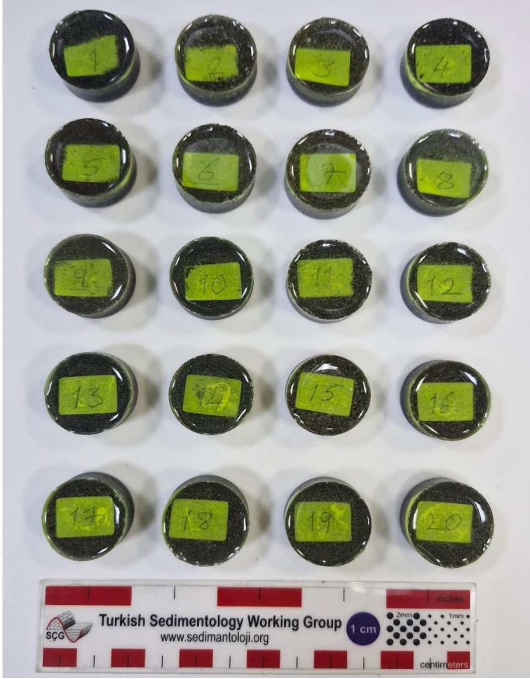
Şekil 6. Ünye sahiline ait kum numunelerinden parlak kesit hazırlamak üzere epoksi içinde kalıplama işlemi
