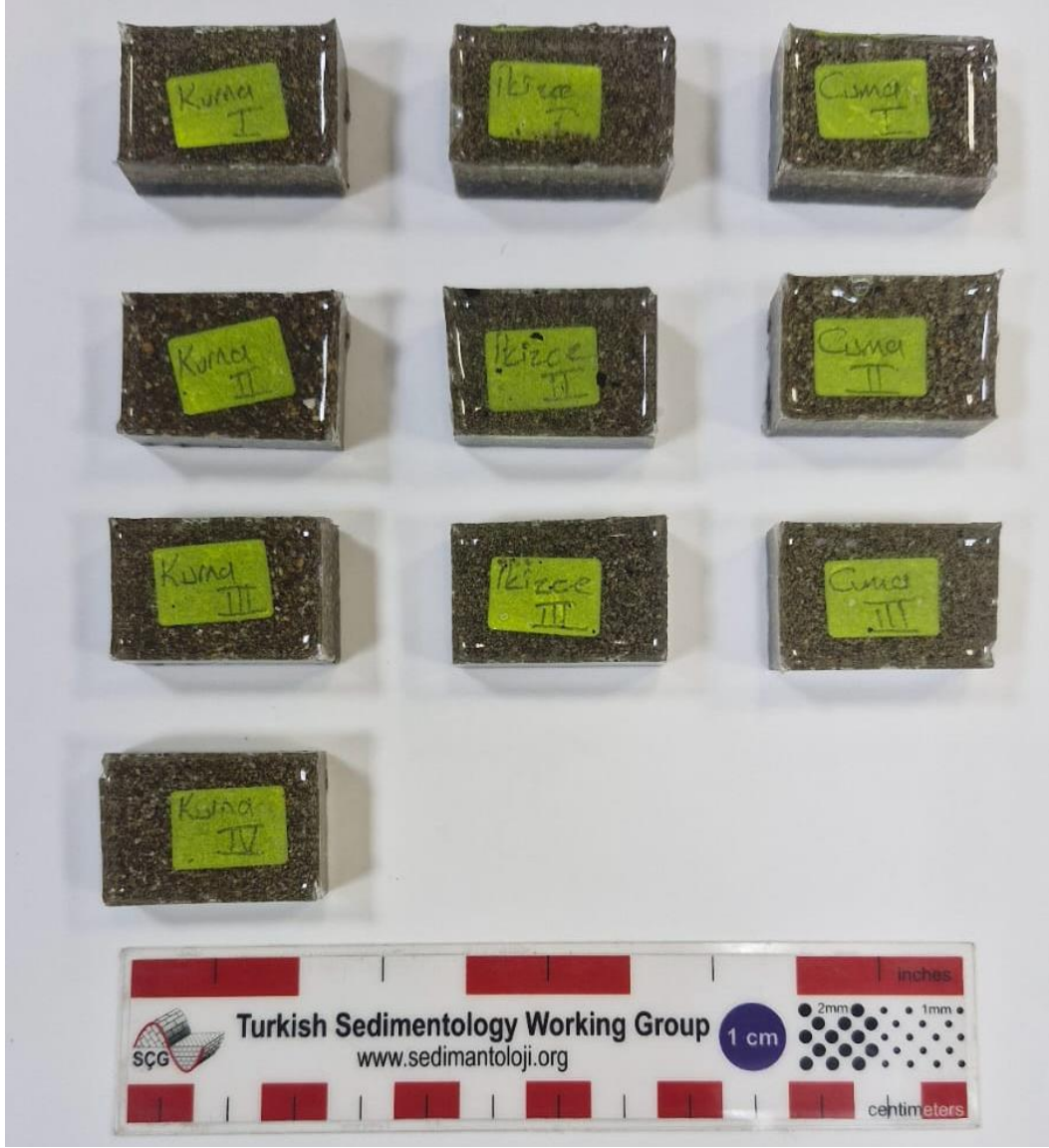
Şekil 7. Cuma dere, İkizce dere ve Kurna dere boyunca alınan kum örneklerinden ince kesit yapmak üzere hazırlanmış epoksi kalıpları
