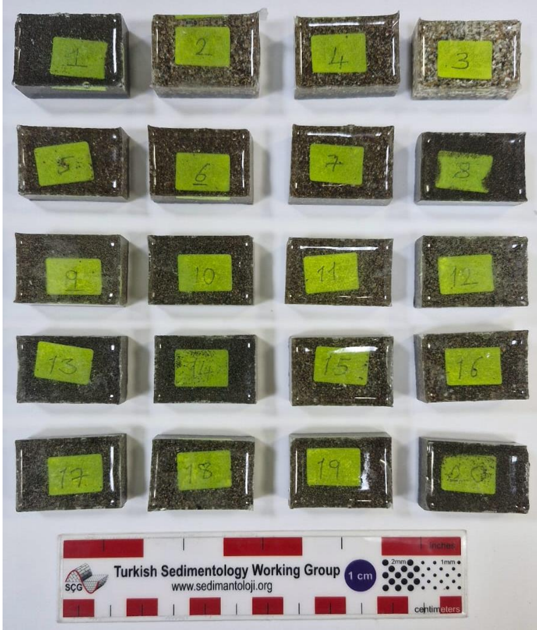
Şekil 5. Ünye sahiline ait kum numunelerinden ince kesit hazırlamak üzere yapılan epoksi içinde kalıplama işlemi
