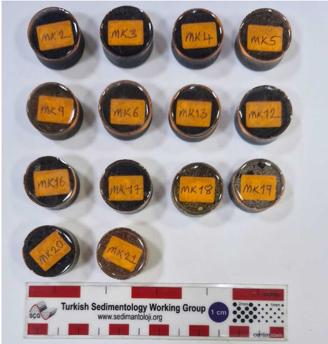
Şekil 10. Ünye ilçesi çevresinde mostra veren kayaçlardan parlak kesit hazırlamak üzere hazırlanan epoksi kalıpları
