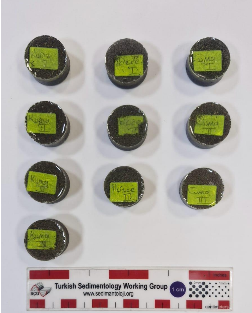
Şekil 8. Cuma dere, İkizce dere ve Kurna dere boyunca alınan kum örneklerinden parlak kesit yapmak üzere hazırlanmış epoksi kalıpları
