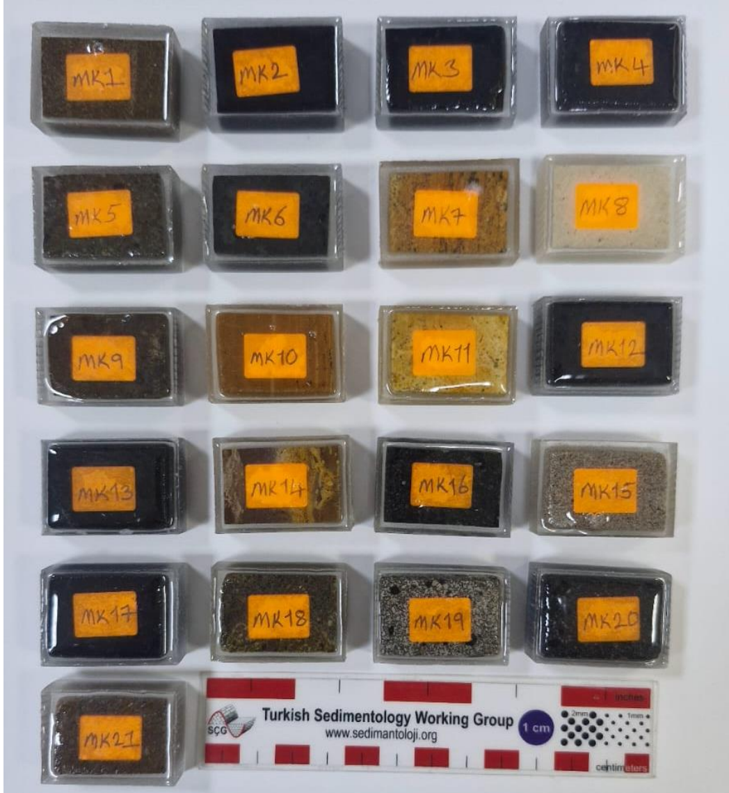
Şekil 9. Ünye çevresinde mostra veren kayaç türlerinden ince kesit hazırlamak üzere hazırlanan epoksi kalıpları
