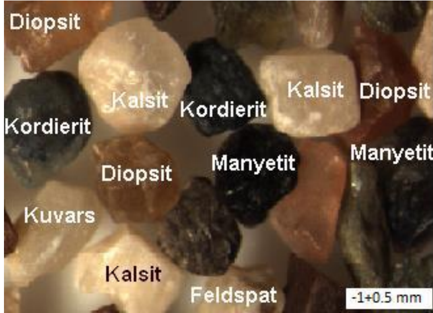
Şekil 15. Sahil kumu elek fraksiyonlarına ait stereo mikroskop görüntüleri
